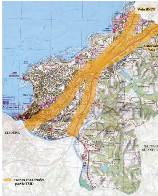
TMD par voies ferrée et routière (source : DICRIM de Saint-Jean-de-Luz)
